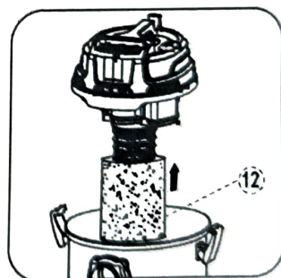
Colocacion filtro de esponja
